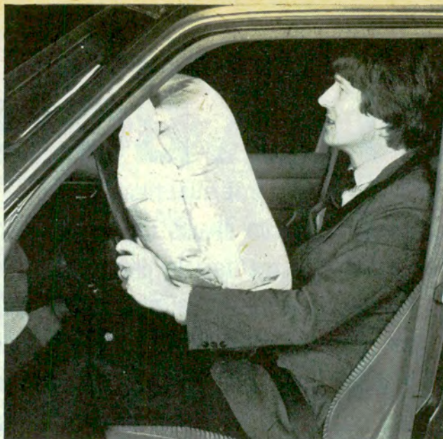
Así emerge la bolsa de aire del centro del volante en los automóviles Mercedes Benz cuando se produce un impacto frontal.
